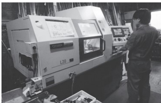
シチズンマシナリー製自動旋盤「L20」の振動切削機能を効果的に使い、難削材の加工に対応
